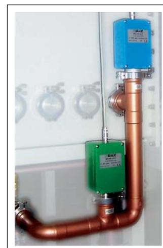
センサーはボックスの出口側に設置されており、真にボックス内の酸素水分濃度を測定する事ができます。
