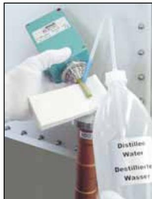
水分センサーを蒸留水で洗い流します
