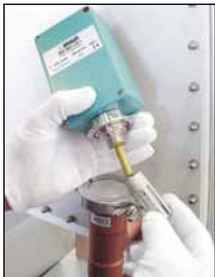
水分センサー保護カバーを外します
