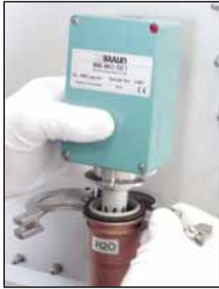
プローブを挿入しクランプで固定します
